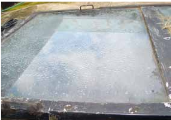
Ungeklärte Feuchtigkeitsansammlung unter der Glasabdeckung des Trockners in Shimoni
